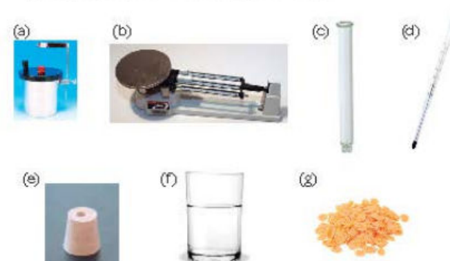
Figura 3.22 El material necesario: (a) calorímetro, (b) balanza granataria, (c) tubo de ensayo, (d) termómetro, (e) tapón horadado, (f) un vaso con agua, (g) hojuelas de maíz.
