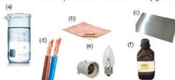
Figura 4.22 Materiales: (a) Vaso de precipitados, (b) laminilla de cobre, (c) laminilla de magnesio, (d) 2 cables de cobre, (e) socket con foco de 3 volts, (f) solución de ácido clorhídrico al 10%.
