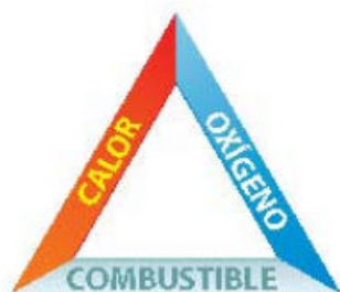
Figura 3.12 Para que haya una combustión se requiere un combustible, un comburente (oxígeno) y calor.
