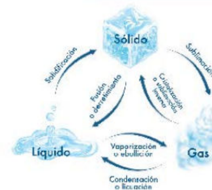
Figura 2.4 Cada uno de los procesos de cambio de estado de la materia recibe una denominación y va acompañado de una variación de energía.
