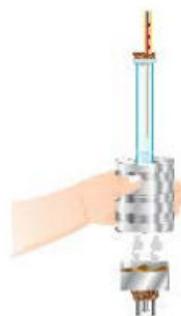
Figura 3.26 Coloquen el calorímetro sobre el tripié, de forma que el tubo de ensayo capte el calor que desprenden las hojuelas de maíz quemadas.
