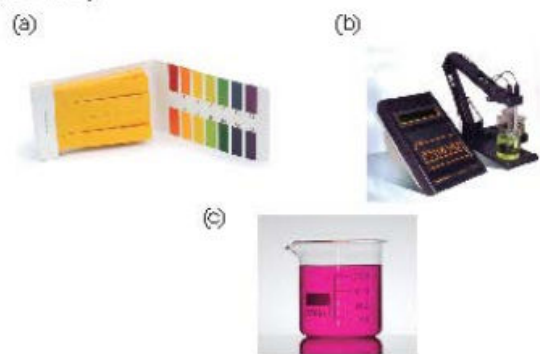
Figura 4.32 Algunas herramientas para medir la acidez o alcalinidad de una sustancia: (a) papel tornasol (o tiras de pH), (b) pH-metro y (c) solución de fenolftaleína.
